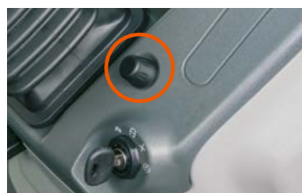
Mit dem Drehknopf navigieren Sie komfortabel durch das Menü. Dieser befindet sich neben der Lenksäule.
