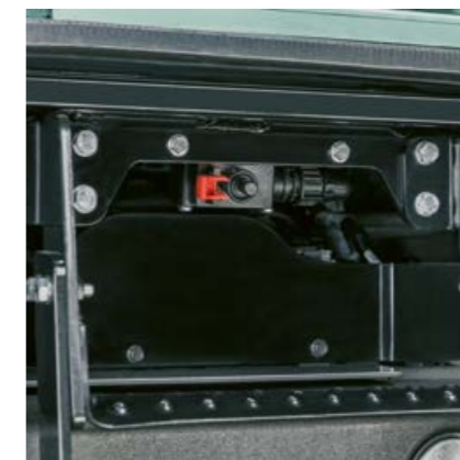
Der Batterietrennschalter ist griffgünstig am linken Einstieg platziert.
